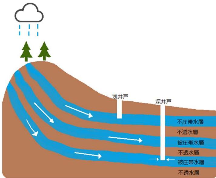
地下には、水を通しやすい「帯水層」と水を通しにくい「不透水層」があり、地下水は帯水層から井戸を通して汲み上げます。
