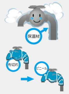
保温材を巻きます。蛇口が破裂しやすいので、絵のように完全に包んでください。
