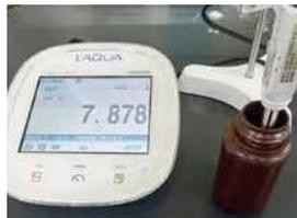
pH測定器を使用し、pH値が検査基準値である5.8以上8.6以下であるかを測定器で測定します。
